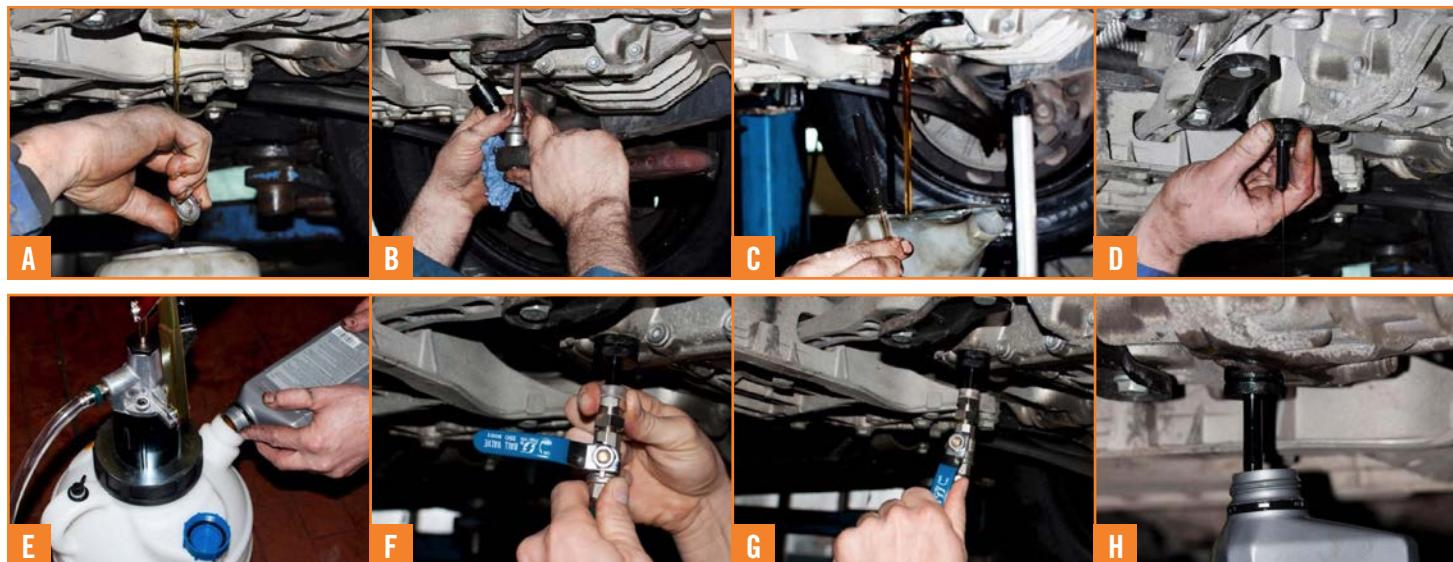
1. Kontrollieren Sie die Getriebeöltemperatur. Falls die Temperatur mehr als 50 °C beträgt, lassen Sie das Öl abkühlen.
